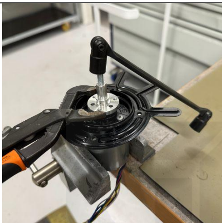
Steg 3: Håll fast navet med exempelvis en polygrip. Använd en 10 mm nyckel på bulten och dra åt – navet pressas då uppåt och lossnar från axeln.
