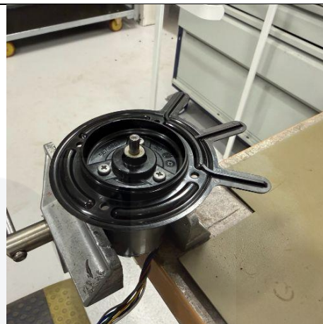
Steg 4: Lossa de tre skruvarna som håller klippmotorplattan på plats.
