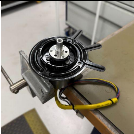
Steg 1: Spänn fast klippmotorn stadigt i ett skruvstäd.
